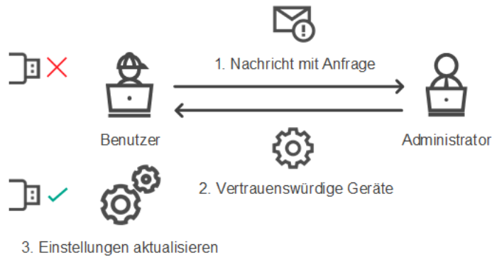
Schema für die Freigabe eines Gerätes im Online-Modus
