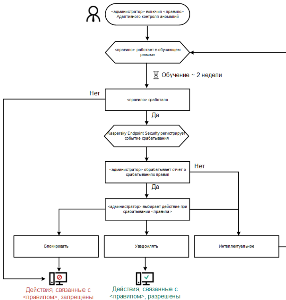
Алгоритм работы Адаптивного контроля аномалий
