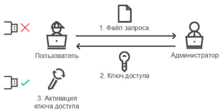
Схема предоставления доступа к устройству в офлайн-режиме
