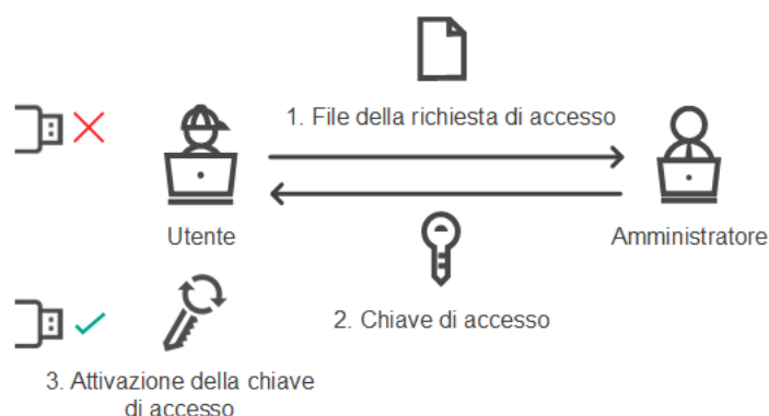
Schema per la concessione dell'accesso a un dispositivo in modalità offline
