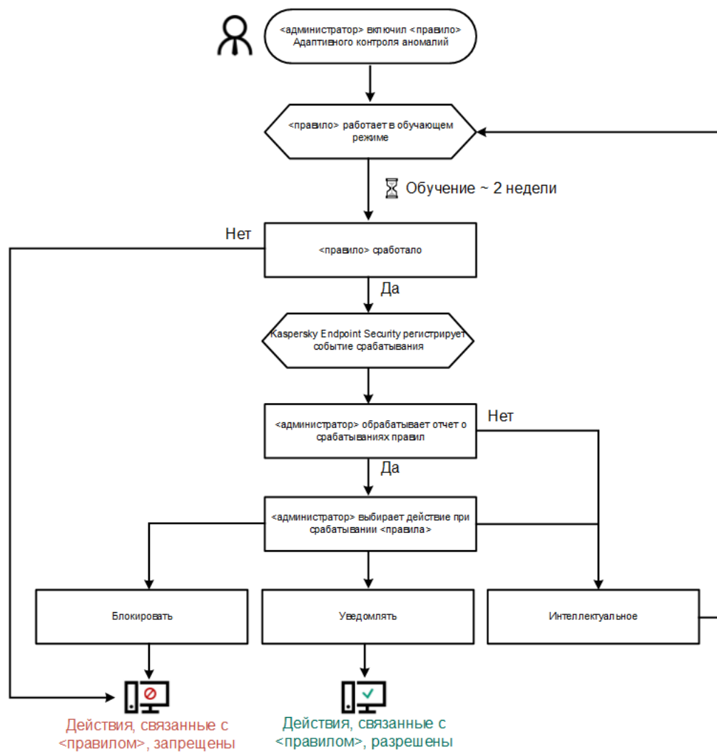
Алгоритм работы Адаптивного контроля аномалий
