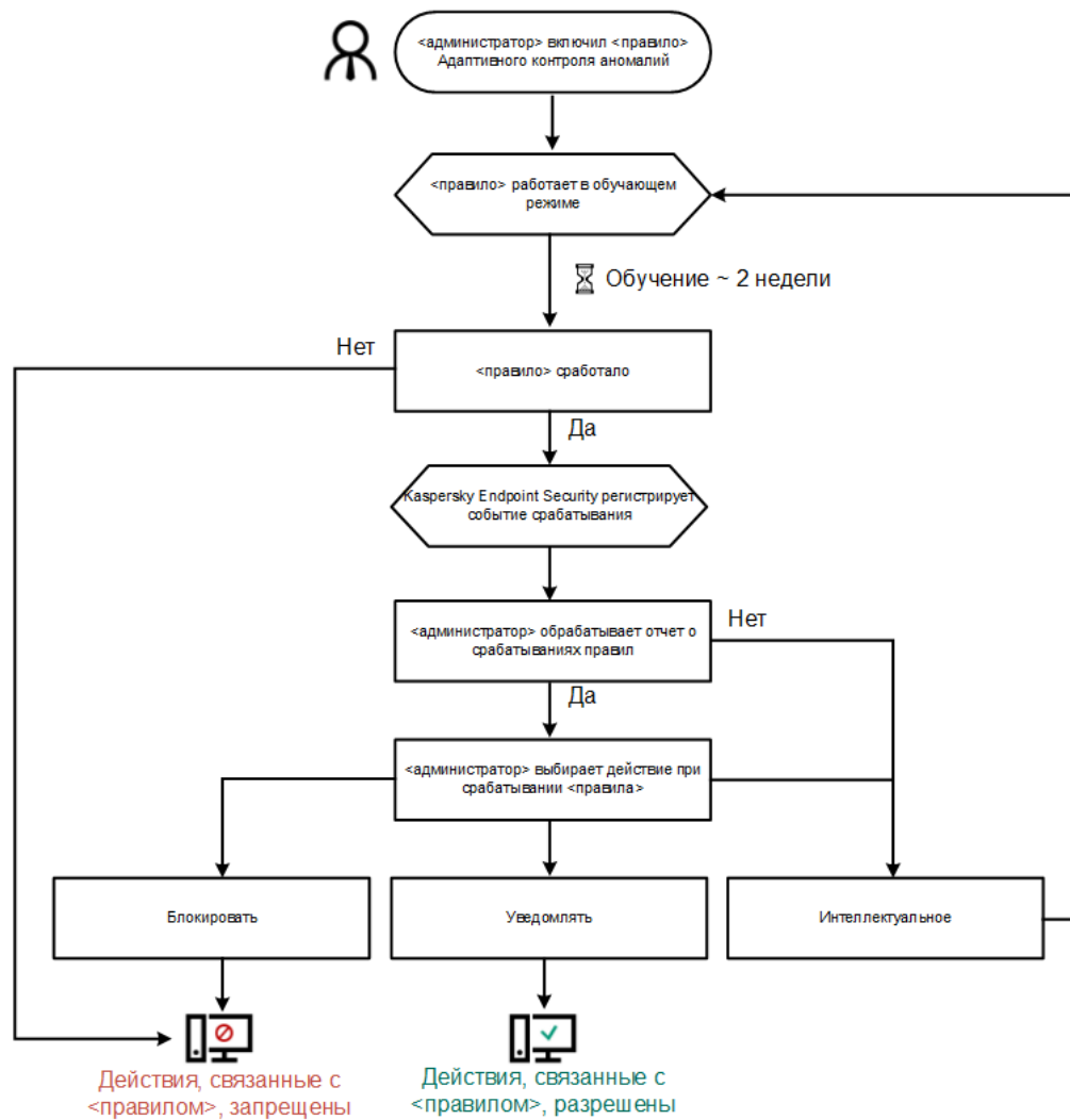
Алгоритм работы Адаптивного контроля аномалий
