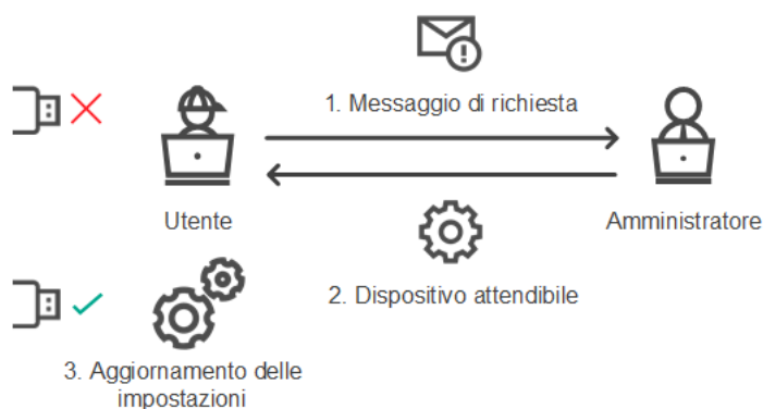
Schema per la concessione dell'accesso a un dispositivo in modalità online
