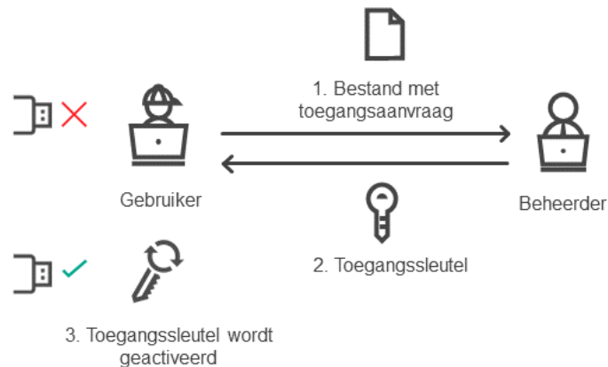
Schema voor het verlenen van toegang tot een apparaat in de offline modus
