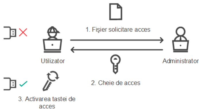
Schema pentru acordarea accesului la un dispozitiv în modul offline
