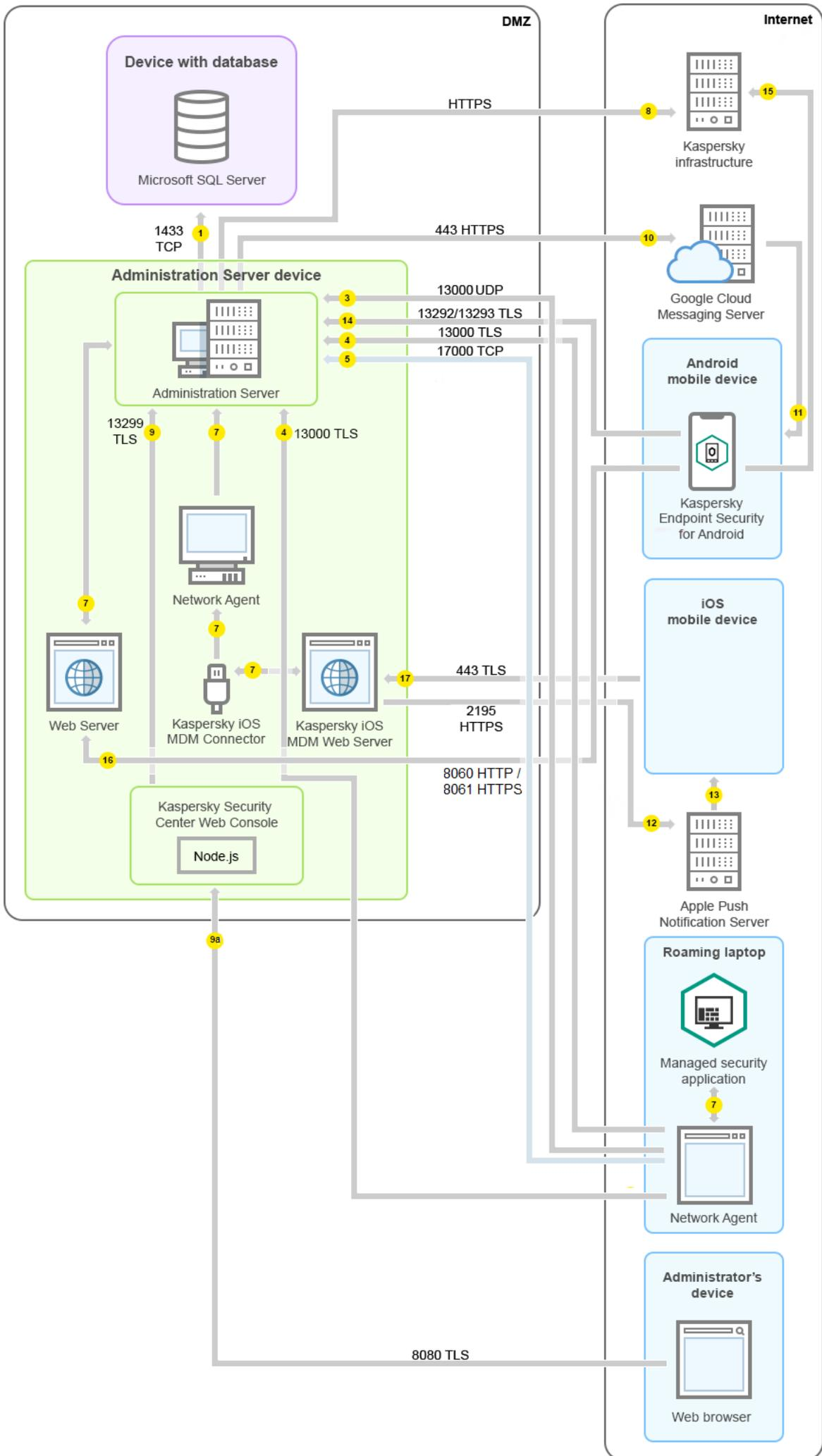
En esta figura, ninguna puerta de enlace de conexión está en uso: los dispositivos móviles se conectan directamente al Servidor de administración.
