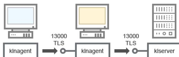
Servidor de administración, una puerta de enlace de conexión en un segmento de red y un dispositivo cliente
