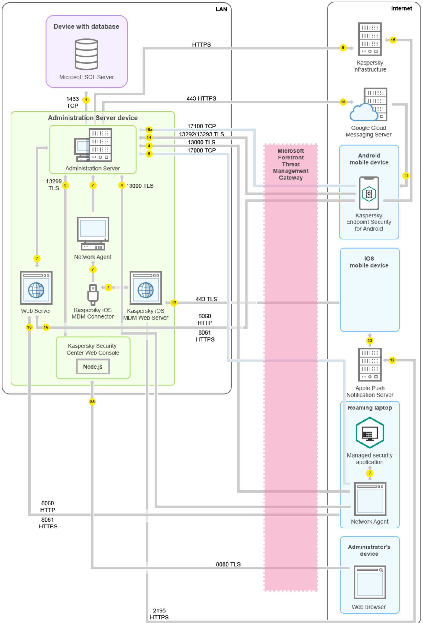
Se recomienda este esquema de despliegue si no desea que los dispositivos móviles se conecten directamente al Servidor de administración y no desea asignar una puerta de enlace de conexión en la DMZ.
