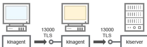
管理服务器、网段连接网关和客户端设备
