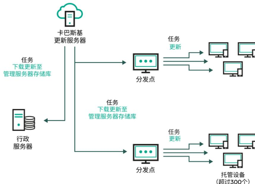
通过使用“将更新下载至管理服务器存储库”任务和“将更新下载至分发点存储库”任务更新
